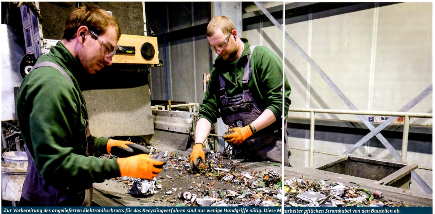
Zur Vorbereitung des angelieferten Elektronikschrotts für das Recyclingverfahren sind nur wenige Handgriffe nötig. Diese Mitarbeiter pflücken Stromkabel von den Bauteilen ab.
